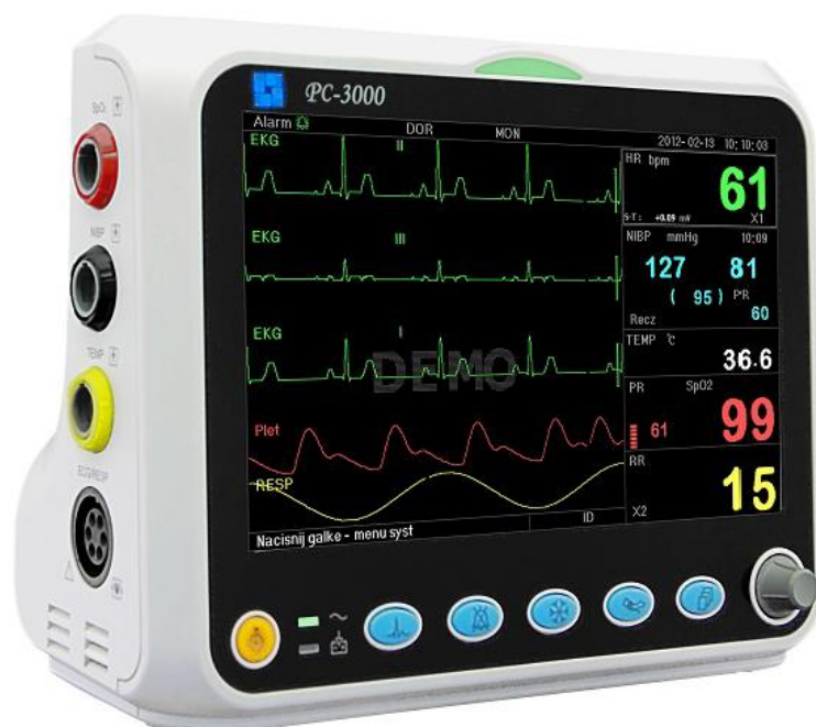
Obr. 5. Kardiomonitor. Vlevo vstupní konektory jednotlivých snímačů. Červená stopa na obrazovce zobrazuje měřený tepenný krevní tlak (IBP) při zasunutí kanyly do radiální tepny.
