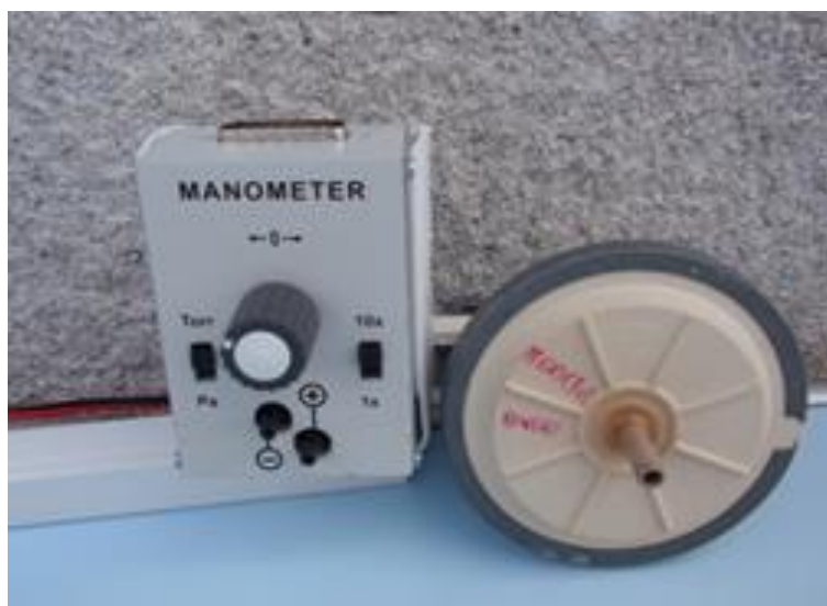
Obr. 7. Manometr ISES a tlakový mikrospínač
