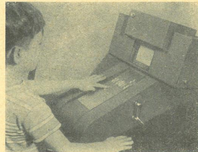
Obr. 9. Videosonic, vyučovací stroj společnosti Hughes Aircraft Company. Promítané obrazy se ukazují na matnici a zvukovou informaci přijímá žák pomocí sluchátek. Žák odpovídá stisknutím příslušného tlačítka nebo ústním sdělením do mikrofону. (Se svolením společnosti Hughes Aircraft Company.)
