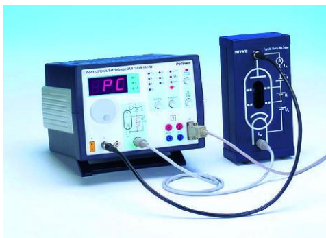
Obr. 7: Tradiční komerční laboratorní pomůcka Franck-Hertz experiment od firmy Phywe (vlevo) provozovaný jako vzdálený experiment iSES Remote Lab SDK (vpravo). http://194.160.213.12/index_js.html na PŘF UKF Nitra, http://147.251.193.82/index.html na Ped MUNI v Brně.
