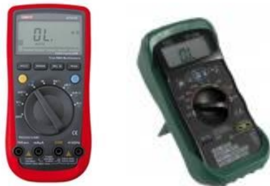
Obr. 5: Universální měřicí přístroje s připojením COM, resp. USB (např. multimetr UT-61E, enviromentální multimetr DT-223, napájecí zdroj PSP 12010), které jsou implementovány v iSES Remote Lab SDK
