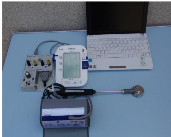
Obr. 10. Měření krevního tlaku tonometrem a ISESem
