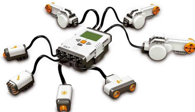
Inteligentní LEGO® NXT kostka a připojení senzorů
