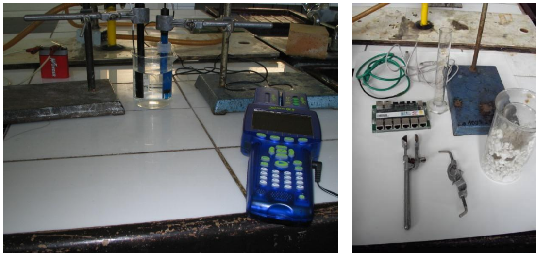
Obr. 1 a 2 Srovnání měřicích sad Dataloggeru PASCO (vlevo) a měřicího rozhraní EdLab (vpravo)
